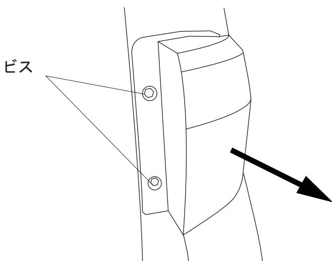
1. ビス2本を取り外し、後方に引き抜き純正テールを取り外します。
