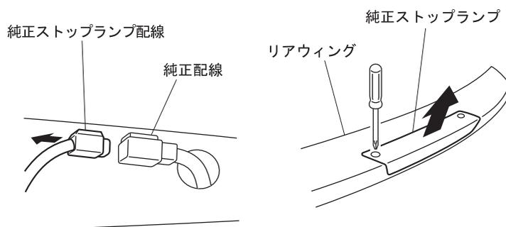
純正ストップランプ配線のコネクタを外して下さい。純正ストップランプ下面のビスを外し、リアウィングから純正ストップランプを外して下さい。
