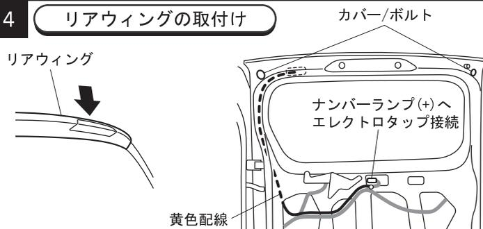
配線を挟まないよう注意して、リアウィングのクリップを留め、バックドア裏側からボルトを締めてカバーを取付けて下さい。
