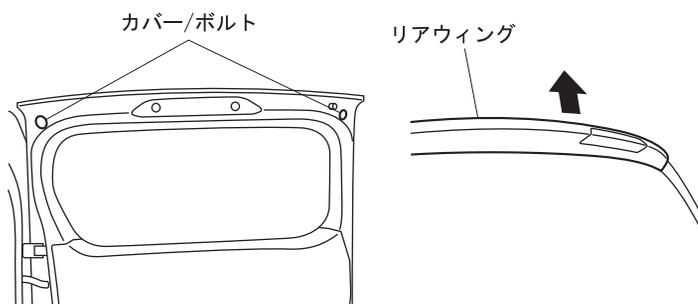
バックドアを開けて両端にあるカバーを外し、リアウィングを固定しているボルトを外して下さい。クリップに注意してリアウィングを外側から外して下さい。
