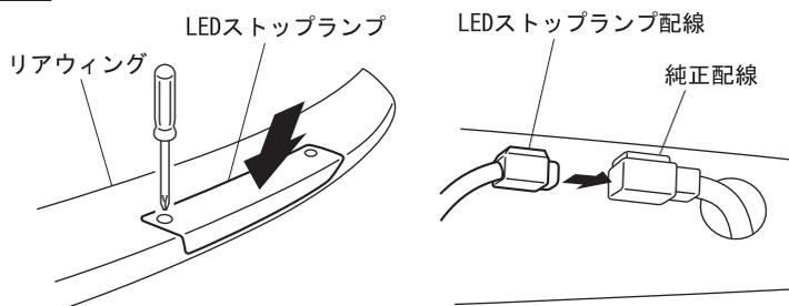
LEDストップランプに純正配線を接続し点灯確認を行って下さい。問題無ければLEDストップランプをリアウィングに取付けて下さい。この時、リアウィング内に配線を通して下さい。スモール連動させない場合は黄色配線を絶縁処理して下さい。LEDストップランプ配線と純正配線のコネクタを接続して下さい。
