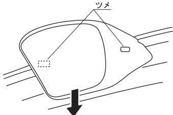
3. 1. レンズが〇印のツメ 4箇所で固定されていますので、取り外して下さい。
