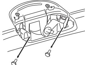
4. 1. 本体端子をユニットソケット穴に通し、車両側ソケットに取り付けて下さい。
