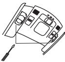
②電球・反射板の取り外し
