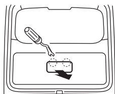
①リアハッチ内張りの取外し
