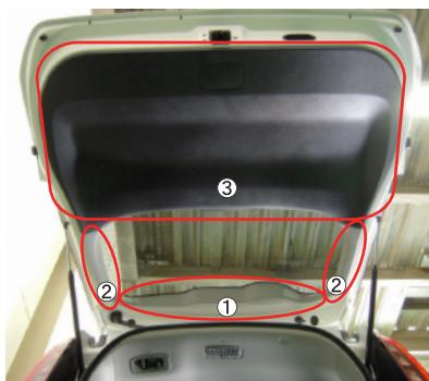
2. 1. 純正パネルの図のカバーを取り外し、商品本体を取り付けて下さい。
