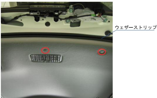
4. 1. ルームランプのレンズを取り外し、○印のロックを解除してルームランプユニットを取り外して下さい。
