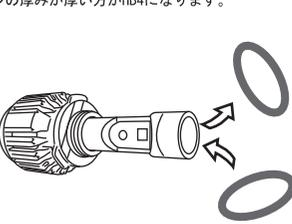
2. HB3とHB4では発光面の位置が異なります。調整ネジを緩め純正フォグランプユニットのリフレクターに合わせて発光面を調整して下さい。
