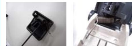
「フューエルボンネットオープナー」へ純正品のスプリングを取り付け、純正オープナーのベースと組付け、純正オープナーから外したワイヤを取り付けます。
