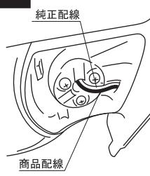
1. カバー・ミラー部を取り外した逆の手順で取り付けて下さい。
