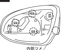
1. 図にあるツメ4箇所を取り外し、カバーを取り外して下さい。カバーを取り外す際、内部にツメが1箇所ありますので、注意して下さい。
