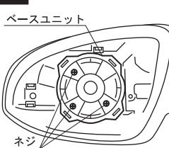
1. ベースユニットを固定しているネジ3箇所を取り外し、ベースユニットを取り外して下さい。
