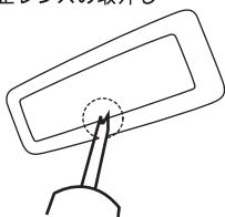
ランプスイッチをOFFにして消灯状態にしてください。図中○印部にドライバーを差込みツメを確認しながらレンズを外してください。
