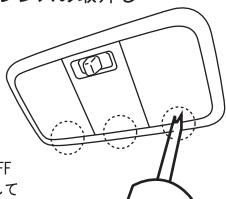
ランプスイッチをOFFにして消灯状態にしてください。図中○印部にドライバーを差込みツメを確認しながらレンズを外してください。
